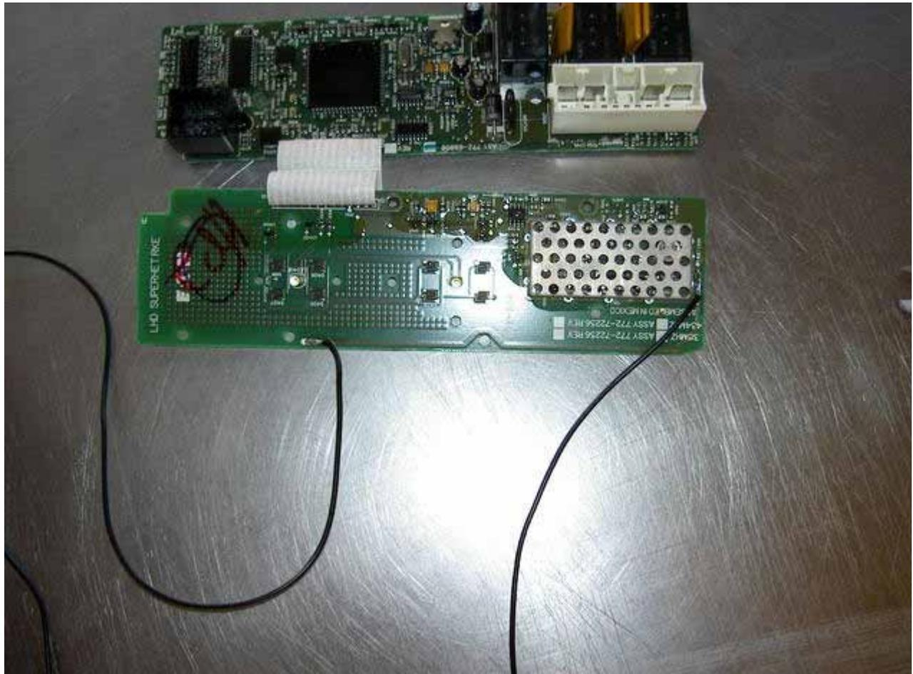
Jetzt könnt ihr das Teil wieder Zusammenbauen: ich habe noch zur Sicherheit die Platine mit ein paar Punkten CA-Kleber angeklebt. Ach ja, für die Kabel müsst ihr eine kleine Öffnung ins Gehäuse machen, damit die schön durchpassen. Alles Zusammenstecken, die 5 Torx anschrauben - fertig!
